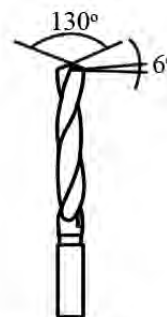
مته برای سوراخ‌کاری المومینیم و مس مته برای سوراخ‌کاری فولاد سخت، برنج و برنز فولاد و چدن مته برای سوراخ‌کاری
